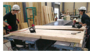
トドマツを使用した住宅用パネル加工風景
